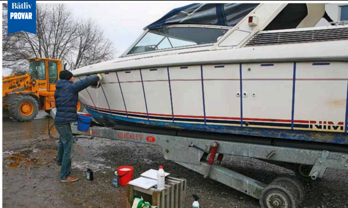
En Nimbus 26 som skulle vinterförvaras var vår "testbänk". Babordssidan delades upp i ett antal fält och här testade vi våra åtta rengöringsmedel.
