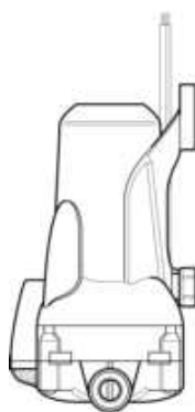
Fig 2 - Orientation recommandée du montage de la pompe
