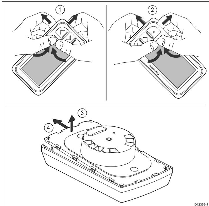
1. Fjern enheden fra monteringsfladen eller monteringsbeslaget, og frakobl kablerne.
