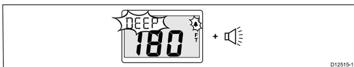
Dybdealarmen er både tilgængelig på i40 Bidata og i40 Dybde instrumenter. Dybdealarmen udsendes, når dybden er lig med dybdealarmens tærskel. Alarmerne udsendes, indtil den afbrydes manuelt.
