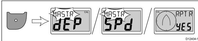
**Bemærk:** Ved i40 Bidata er det nødvendigt, at du trykker en ekstra gang på knappen **Handling** for at skifte fra dybde instrument status og hastigheds instrument status.
