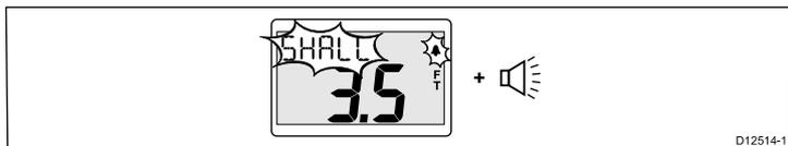
Alarmerne for lavvande er både tilgængelige på i40 Bidata og i40 Dybde instrumenter. Alarmerne for lavvande udsendes, når dybden er lig med eller mindre end tærsklen af alarmerne for lavvande. Alarmerne udsendes, indtil den afbrydes manuelt.
