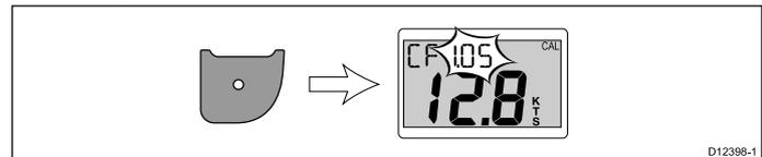
15. Brug knappen **Op** til at øge værdien af kalibreringsfaktoren eller knappen **Ned** for at mindske værdien af kalibreringsfaktoren.
