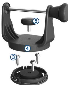
5 Установите поворотный кронштейн ④ на поворотное основание и закрепите его с помощью короткой ручки ⑤.
