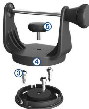
5 Amplasați consola pivotantă de montare ④ peste baza pivotantă și fixați-o cu un buton scurt ⑤.
